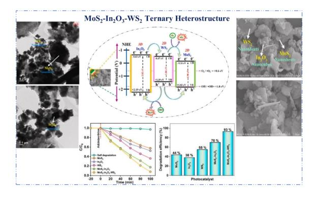
功構建,這一點亦可從 SEM 與 HR-TEM 影像中得到支持。所合成的 MoS2-In2O3-WS2三元複合材料在可見光照射下顯示出對抗菌劑(如三氯生 (TCS) 與三氯卡班 (TCC))的卓越光催化活性,其中 TCS 的光催化降解率在 90 分鐘後達到 95%,而 TCC 則在 100 分鐘後達到 93%。經過四次連續光催化循環後,使用 FTIR 與 SEM 分析所製備的 MoS2-In2O3-WS2三元複合材料的再使用性與穩定性,結果顯示該材料具有良好的穩定性與可重複使用性。綜合結果表明,所開發的 MoS2-In2O3-WS2 (2D/3D/2D) 多奈米結構作為光催化劑,具有低成本且環保的優勢,展現出在廢水中去除抗菌劑的潛力。
